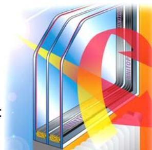
Die Isolierung zwischen der Innen- und der Außenscheibe funktioniert, die Heizwärme bleibt im Raum und die Außenscheibe am Morgen kalt. So kann es vorübergehend zu Kondensation kommen.
